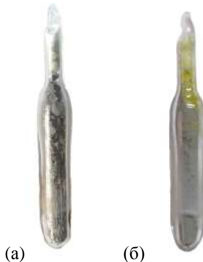
Рис. 3.12 – Зміна забарвлення систем: а) \text{Lu}_2\text{S}_3\text{-LuF}_3 вихідна суміш до термообробки; б) ймовірний \text{LuSF} після термообробки при 900^\circ\text{C}
