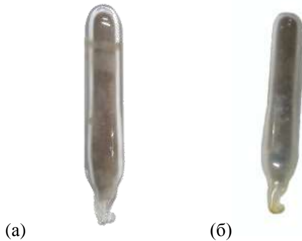
Рис. 3.11 – Зміна забарвлення систем: а) \text{Ce}_2\text{S}_3\text{-CeF}_3 вихідна суміш до термообробки; б) ймовірний \text{CeSF} після термообробки при 750^\circ\text{C}
