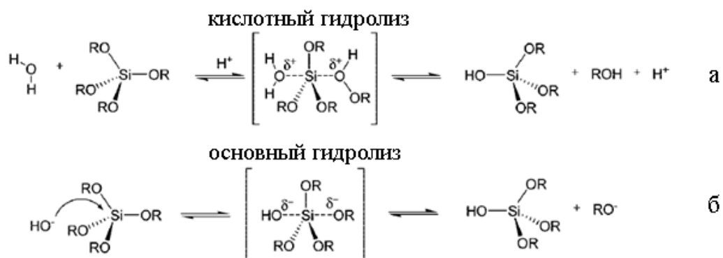
Рис. 1.3. Механизмы кислотного (а) и основного (б) гидролиза тетраалкоксисиланов
